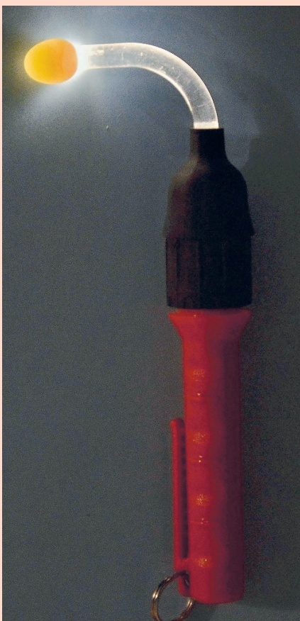
▲ Baterka s optickým nastavcom, pomocou ktorej zisťujeme oplodnenosť znášky
